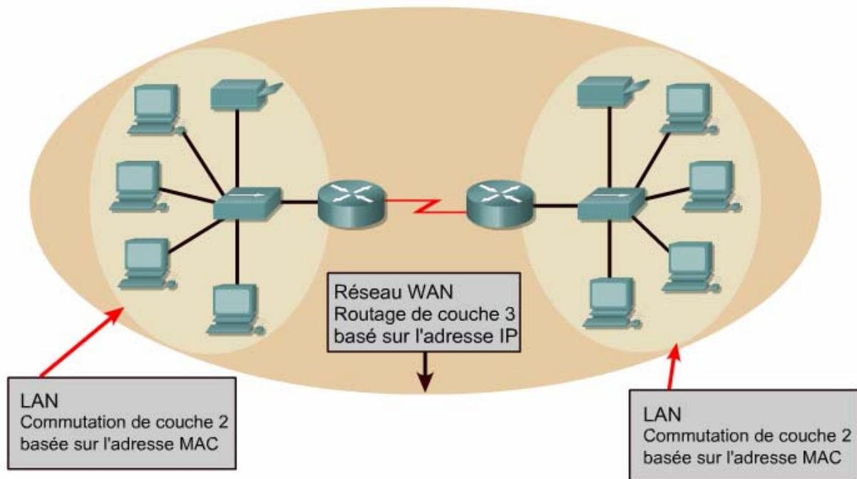
La commutation de couche 2 s'effectue au sein du réseau LAN. Le routage de couche 3 achemine le trafic entre les domaines de broadcast. Cela nécessite le format d'adressage hiérarchique d'un système d'adressage de couche 3, tel que IP.
