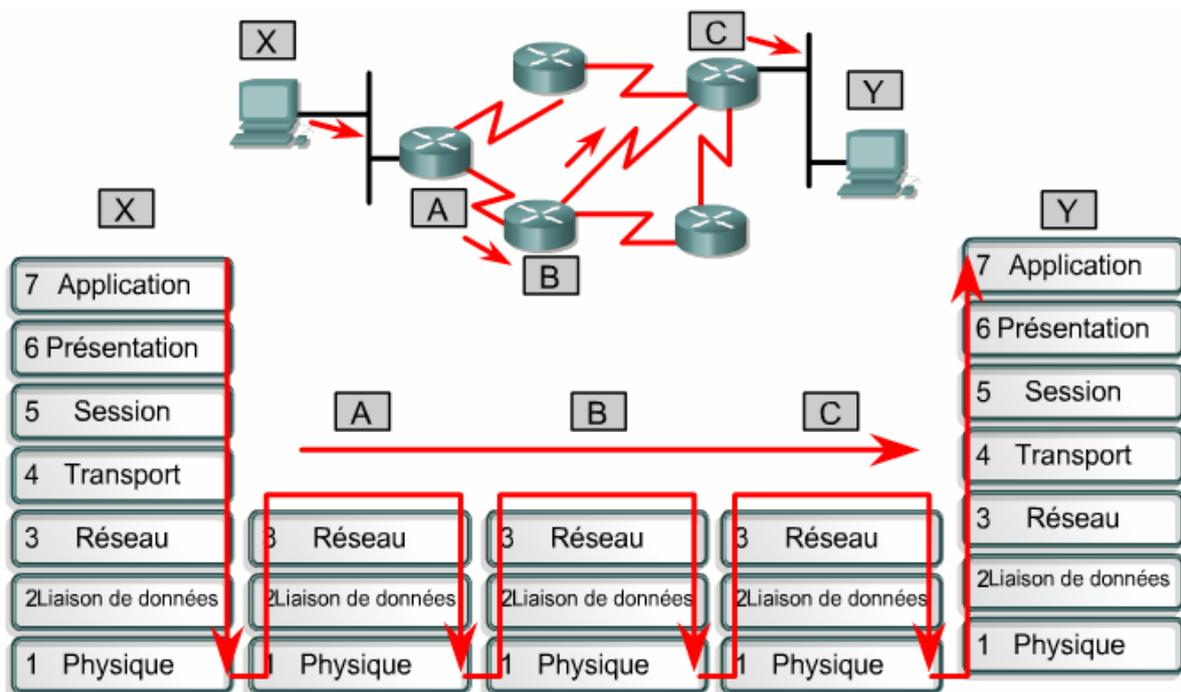
Le flux de données dans un réseau concerne les couches 1, 2 et 3 du modèle OSI. Il s'agit donc du trajet entre la transmission des données par l'hôte émetteur et leur arrivée au niveau de l'hôte récepteur.
