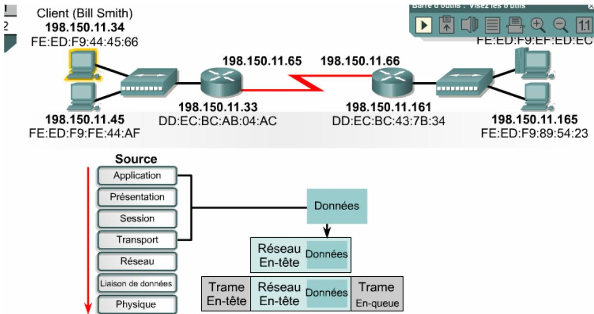
La couche transport segmente, séquence et ajoute le contrôle d'erreur au message électronique. Les adresses source et de destination de la couche réseau sont ajoutées au datagramme. Le cache ARP fournit l'adresse MAC correspondant à l'adresse IP de destination. Ainsi, la trame Ethernet est ajoutée et comprend les adresses source et de destination.
